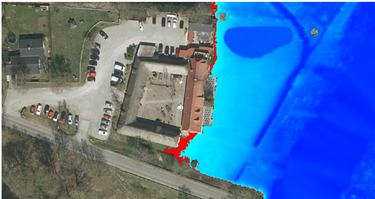
Figur 3. Effekt af magasinering i Silkeborg Søerne på oversvømmelse ved Svostrup Kro. Rød = yderligere oversvømmelse pga. manglende magasinering.
